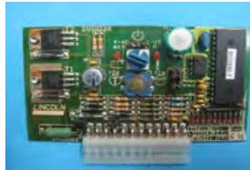
**Steuerplatine für Pumpen mit Endschalter**
