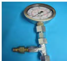
**Rep Satz Drucküberwachung für Pumpenabgang**
