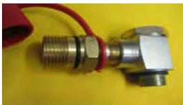
Schwenkverschraubung Pumpenbefüllanschluß 90°
