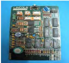
**Steuerplatine Lincoln elektrische Fließfettpumpe**
