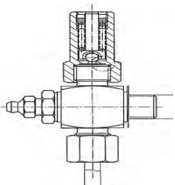
Überdruckventil 90c 300 Bar
